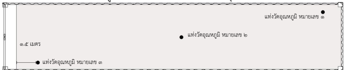
ภาพที่ ๑ ตำแหน่งการวางแท่งวัดอุณหภูมิผลไม้ภายในตู้ขนส่งสินค้าสำหรับการกำจัดศัตรูพืชด้วยความเย็นระหว่างขนส่ง
