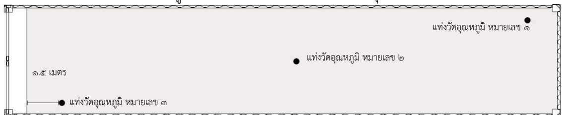
ภาพที่ ๑ ตำแหน่งการวางตำแหน่งวัดอุณหภูมิผลไม้ภายในตู้ขนส่งสินค้าสำหรับการกำจัดศัตรูพืชด้วยความเย็นระหว่างขนส่ง
